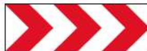
K 8 - Multichevron : signal de position d'une déviation ou d'un rétrécissement temporaire de chaussée.
